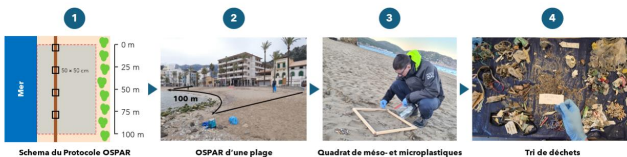
Figure 3: Processus d'échantillonnage des micro- méso et macroplastiques
